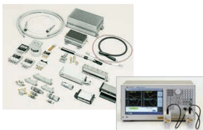
两个 U1810B USB 同轴开关，直流至 18 GHz， ENA 测试端口上的 SPDT
